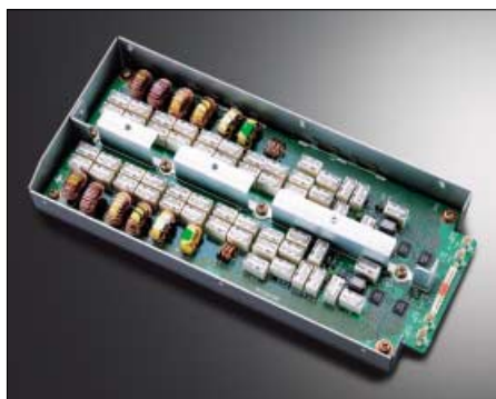
Die digital gesteuerte Preselektor-Einheit mit zwei Preselektoren für die beiden Empfänger
