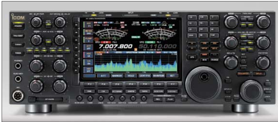
Ganz Icom-typisch das Design, auffällig das hochauflösende 7-Zoll-Farb-TFT-Display. Die Abmessungen betragen 424 mm x 149 mm x 435 mm, das Gewicht 25 kg.
