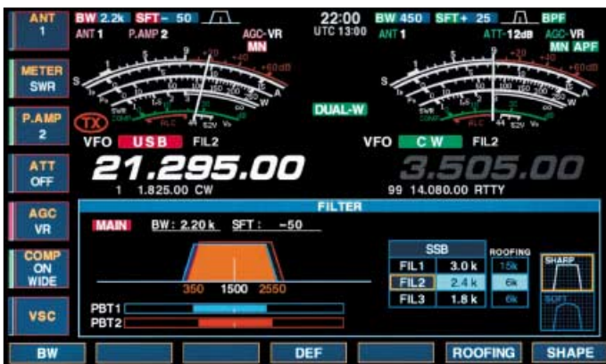
Display des IC-7800, in dem zugleich die Angaben zum Haupt- und Subband sowie die Filtereinstellungen dargestellt werden
