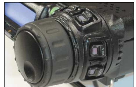
Bild 3: Gewöhnungsbedürftig, aber ergonomisch zweckmäßig: Tasten oberhalb und rechts neben dem Hauptabstimmknopf
