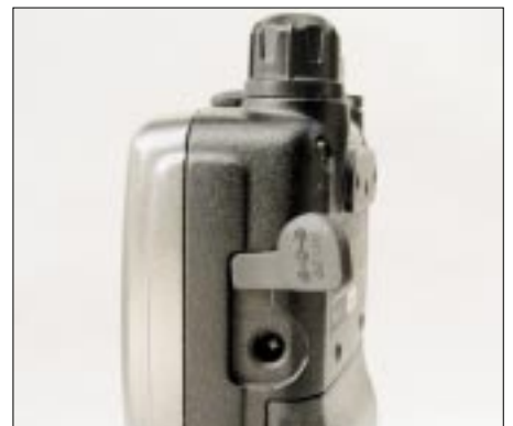
Auf der rechten Seite befindet sich die Stromversorgungs-/Ladebuchse. Der Akku bauscht das Profil etwas auf.
