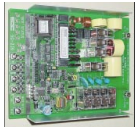
Bild 2: Blick auf die Platineoberseite mit den HF- und Steuerungsbauteilen Fotos: DK7ZB
