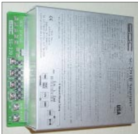
Bild 1: Tuner im nicht regendichten, aber preisgünstigen Aluminiumgehäuse
