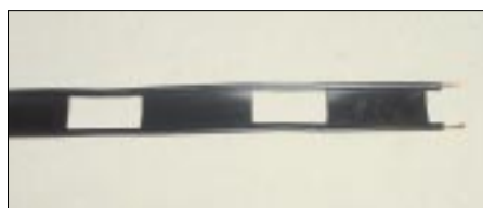
Bild 6: Symmetrische 450- \Omega -Speiseleitung US-Wireman – im Amateurfunkfachhandel erhältlich
