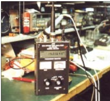
Messung der Eigenresonanz der mitgelieferten Antenne im Shack bei DG8JZ
