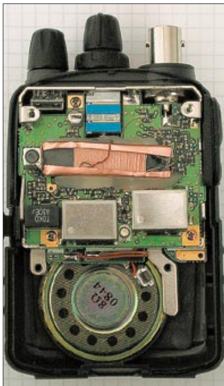
Winzig – und dennoch paßte ein Ferritstab mit hinein.
