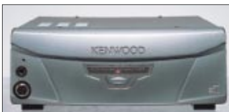
TS-2000 und das fernbedienbare Pendant TS-B2000 mit lediglich einer Power-Taste an der Frontplatte sind ansonsten elektrisch praktisch identisch.
