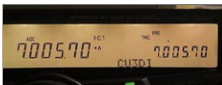
DX-Cluster-Meldungen erscheinen in der untersten Zeile des Displays.
