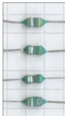
Bild 4: 33 pF in für 2,5 und 5 mm Raster Bild 5: Bei den 2,2-µH-Festinduktivitäten (3. v. o.) sind die roten Ringe eher braun. Bild 6: Bauzustand am Ende von Phase 1 (r.)
