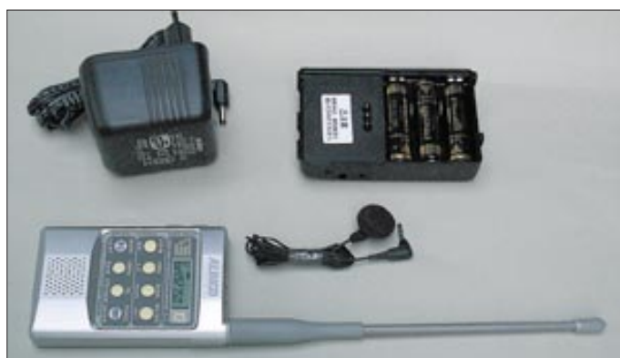
Im Lieferumfang: Knopf fürs Ohr, Ladeteil/Batterie-kasten und Steckernetzteil für die Ladung
