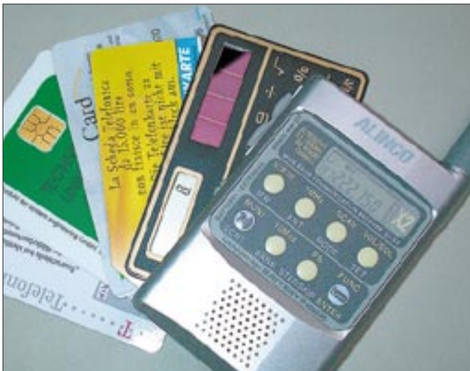
Kein Kartentrick: Der Suchlaufempfänger DJ-X2E belegt nur die Fläche einer Scheckkarte, allerdings ist er deutlich stärker. Fotos: U. Flechtner
