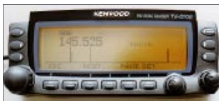
Bild 7: Das Spektrumdisplay umfaßt bei breiter Einstellung das gesamte 2-m-Band im 12,5-kHz-Raster. Ein Durchlauf nimmt nur 11 s in Anspruch – das ist Spitzenklasse!
