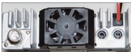
Bild 3: Ein Lüfter bestimmt die Ansicht der Rückseite, dazu die N-Buchse für die Antenne und zwei 3,5-mm-Klinkenbuchsen für Haupt- bzw. Subband-Lautsprecher.
