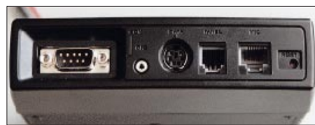
Bild 2: Gerätefront mit neunpoliger D-Sub-Verbindung, 2,5-mm-GPS-Klinke, Mini-DIN-TNC-Anschluß, Westernbuchsen für Mikrofon und Bedienteil sowie versenktem Reset-taster.
