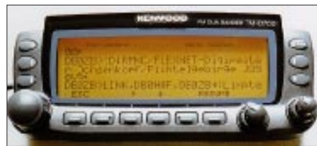
Bild 8: Packet-Radio »PnP« klappt, auch im KISS-Modus, TX-Delay bis herab zu 7, spielt mit DAMA-fähigen Digis zusammen und sogar PACSAT (PR via Satellit) ist möglich!
