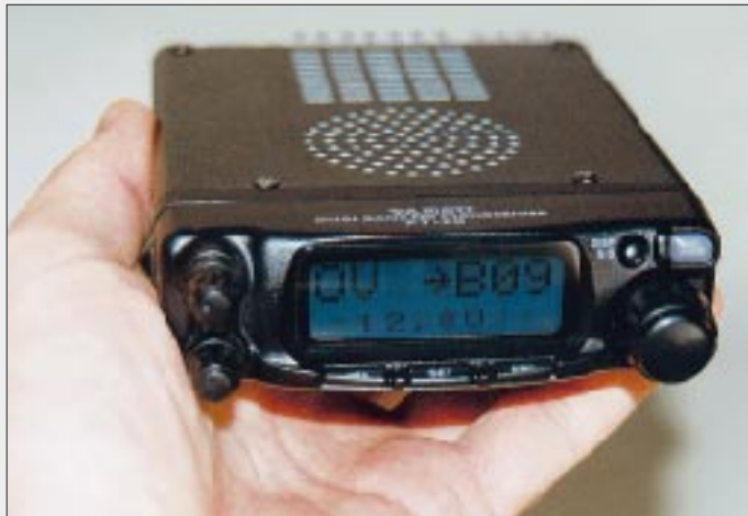
Das Mobilgerät FT-90R liegt sogar noch gut in der Hand. Sein Punktmatrixdisplay zeigt je nach Wahl u.a. den Speicherplätzen zugeordnete Namen und die Betriebsspannung an.
