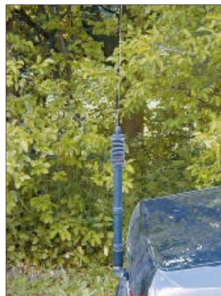
Die Automatikantenne ATAS-100, mit der für diesen Zweck wohl gerade ausreichend dimensionierten Halterung am Kofferraumdeckel eines 7er BMW montiert.
