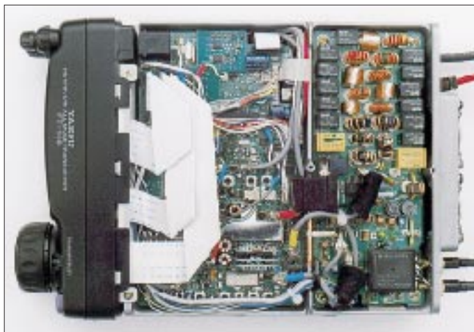
Innenansicht von oben. Unter den Flachbandkabeln verbergen sich die zwei maximal nachrüstbaren Filter. Die Leiterplatte links ist auch unten dicht mit Mini-SMD-Bauelementen besät. Rechts die Antennenfilter
