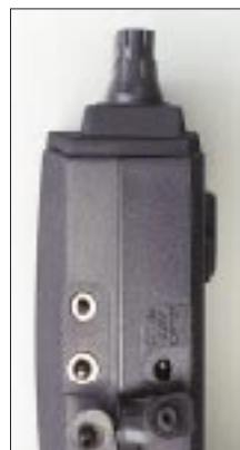
Buchsen zur externen Stromversorgung, für Mikrofon und Lautsprecher sind in Kenwood-Belegung vorhanden.
