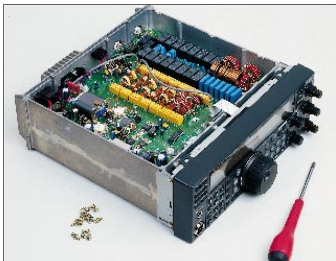
Bild 1: Nach Abnahme des oberen Gehäusedeckels und allerhand Abschirmblechen bietet die obere Leiterplatte den Anblick vieler geschalteter Spulen, Ringkerne und Kondensatoren.
