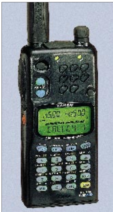
Bild 1: Frontansicht des FT-51E. Unten im Display die achtstellige alphanumerische Anzeige (60 Zeichen wählbar)
